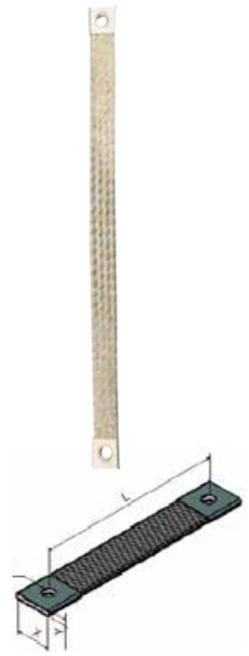
Sección: 25 mm 2 Ø Agujero: 8,5 mm Longitud: 300 mm
