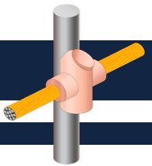
**1.** Empleando un cepillo metálico, limpiar los conductores a soldar // À l'aide d'une brosse métallique, nettoyer les conducteurs à souder // Using a metal brush, clean the conductors to be welded.
