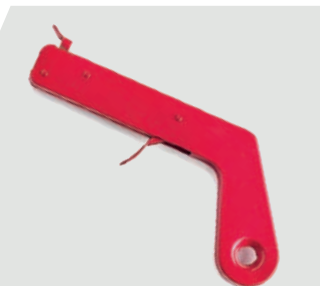
Pistolet d'allumage. Utilisé pour la mise à feu de la poudre d'allumage. Les pierres normales de briquet sont également valables comme recharge.
